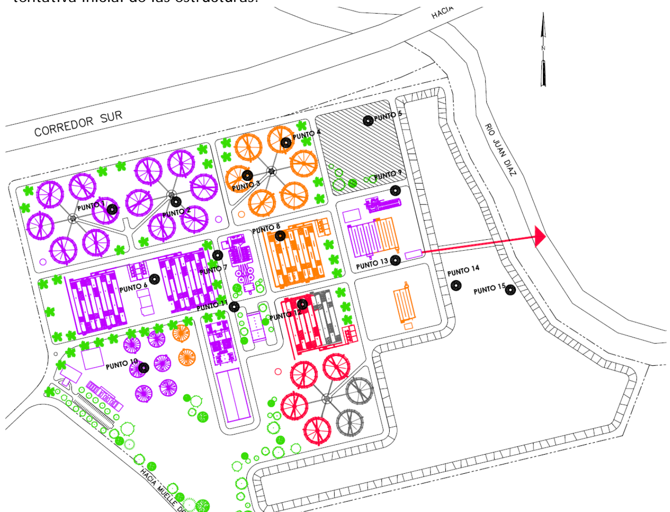
Figura 3.1 - Ubicación Tentativa de las Estructuras de la Planta y Localización de los Sondeos
