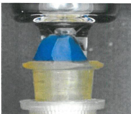
Fig. 2 Vista lateral de la fuga en una jeringa con punta recubierta de cerámica en la conexión de la punta de la jeringa y el centro de la aguja durante la preparación y administración de la vacuna. El área azul representa una mayor pérdida de volumen.
